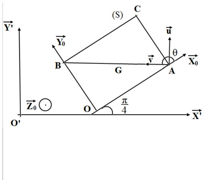
On introduit aussi un autre repère orthonormé direct  $R(A, \vec{u}, \vec{v}, \overline{Z}_0)$  lié au solide (S) et obtenu à partir de  $R_0$  par une rotation angle  $\left(\theta - \frac{\pi}{2}\right)$  autour de l'axe  $\overline{OZ}_0$ .
